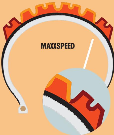
Unsere schnellste 3C Mischung für XC und einige AllMountain/Enduro Reifen ist durch den harten Unterbau und die schnelle Mischung in Laufflächenmitte auf geringsten Rollwiderstand ausgelegt, bietet aber mit der griffigen Mischung an den Seiten dazu noch überlegenen Grip in Kurven, auch bei Nässe. Typisch MAXXIS ist auch die sehr lange Lebensdauer.
